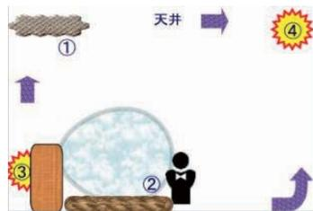
スピーカー背後の天井①にも吸音材を設置します。スピーカー後方への音場の広がりを改善し、リスニングルーム全体への音の広がりと定位（立体）感を大きく改善できます。
